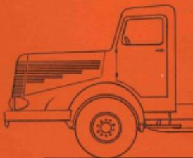
La position caractéristique du moteur en avant de l'essieu AV assure toujours une charge suffisante sur celui-ci, même à vide, ce qui est un facteur essentiel de bonne tenue de route.
