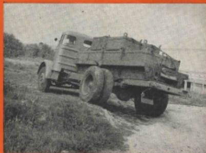
Des châssis prélevés périodiquement sur la production courante sont soumis à des essais à pleine charge sur les pistes spéciales de Monthiery.
