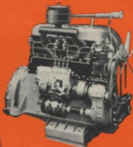
Bien que les moteurs de petite cylindrée tournant vite soient de construction moins onéreuse, UNIC a choisi la solution éprouvée du moteur de grosse cylindrée à régime modéré et grande réserve de puissance. La longévité d'un tel moteur et sa sûreté de marche compensent très largement son coût initial.
