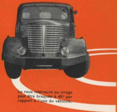
La roue intérieure au virage peut être braquée à 45° par rapport à l'axe du véhicule.
