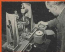
Machine à vérifier les engrenages.
